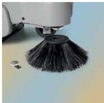
Center- og sidebørster kan udskiftes uden brug af værktøj.
